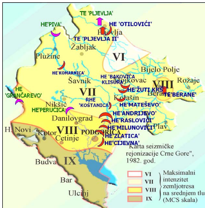
Karta seizmičke rejonizacije Crne Gore sa položajem postojećih i planiranih energetskih objekata.
