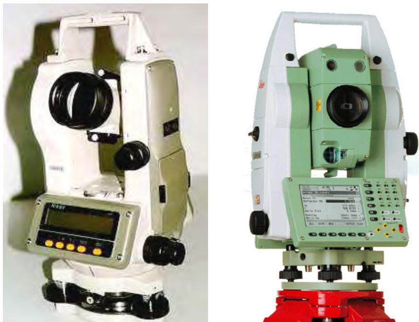
Slika 144. Izgled savremenog elektronskog digitalnog teodolita (lijevo) i totalna stanica tipa "Lajka" TPS1200 (desno) koja omogućuje potpuno automatizovano snimanje zadatih kompleksnih objekata i površi.
