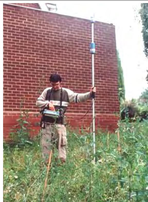
Slika 71a. Mjerjenje geomagnetskog polja protonskim magnetometrom.
