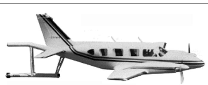
Slika 72. Aeromagnetska spitanja koriscenjem avionskog premjera. Magnetski senzor je lociran ispod repa aviona.
