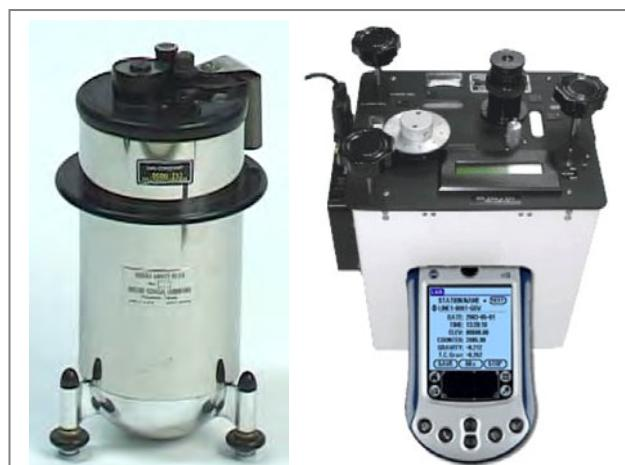
Slika 56a. Izgled savremenih gravimetara za mjerjenje razlike ubrzanja: Vordenov tip (Worden) lijevo i La Costa Ramberg (La Coste Romberg) desno.
